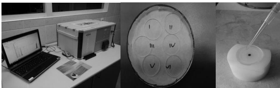
Rys.2. Od lewej: Aparatura pomiarowa PICOFOX w Laboratorium Fizyki UJK w Kielcach, podkładki pomiarowe, nakrapianie próbki na podkładkę pomiarową
