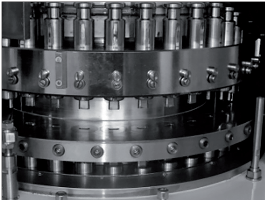
Fot. 3. Prasa rotacyjna do produkcji tabletek (Jachowicz 2016)
