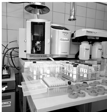
Rys. 2. Oznaczanie z wykorzystaniem ASA oraz krzywa wzorcowa. Opracowanie własne – fot. Klaudia Kubicka
