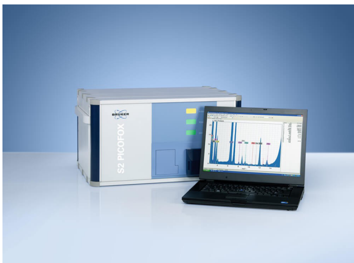
Rys. 3. Zdjęcie spektrometru rentgenowskiego S2 Picofox ( www.portaspecs.com/s2picofox , dostęp: 25.02.2024)
