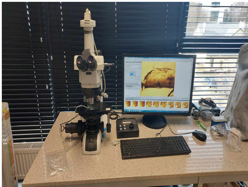
Rys. 2. Stanowisko do analizy struktury mikroskopowej
