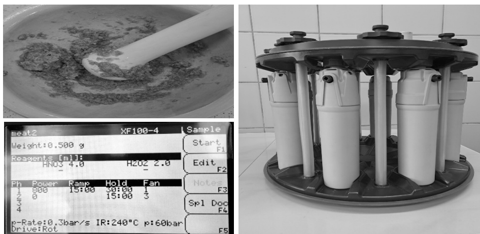
Rys. 1. Etapy przygotowania próbek: ucieranie w moździerzu, mineralizacja. Opracowanie własne – fot. Klaudia Kubicka
