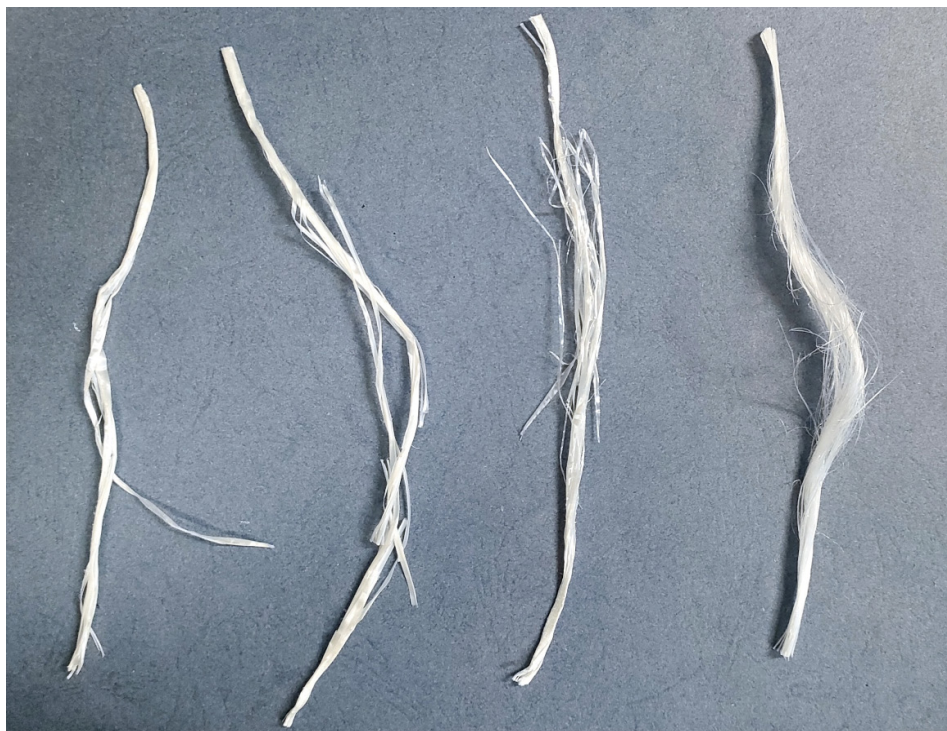
Rys. 5. Struktura makroskopowa przełomów sznurka po badaniach mechanicznych w podwyższonej temperaturze (55°C) dla próbek, od lewej: 1480TEX, 1550TEX, 1850TEX oraz PP
