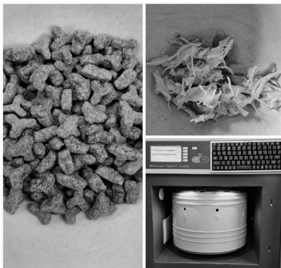
Rycina 1. Etapy przygotowania próbek do analizy: ucieranie próbki suchej i mokrej karmy w moździerzu, mineralizacja w zamkniętym systemie wspomaganej mikrofalami. Źródło własne – fot. Klaudia Kubicka.
