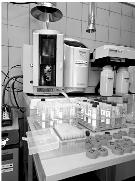
Rycina 2. Pomiary z wykorzystaniem techniki atomowej spektrometrii absorpcyjnej. Źródło własne – fot. Klaudia Kubicka.
