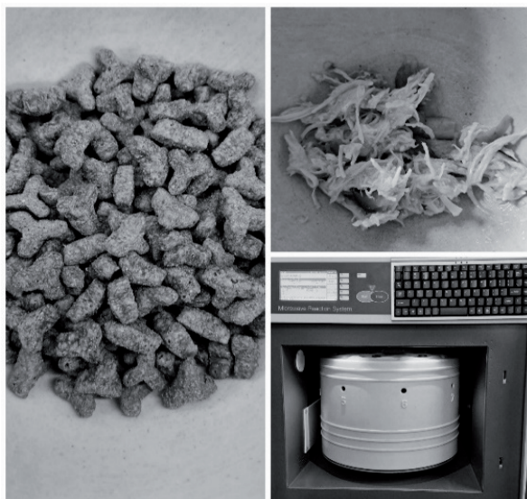
Rycina 1. Etapy przygotowania próbek do analiz: ucieranie próbki suchej i mokrej karmy w młynku, mineralizacja w zamkniętym systemie wspomaganym mikrofalami. Źródło własne – fot. Klaudia Kubicka.
