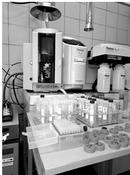
Rys. 3. Pomiary z wykorzystaniem techniki atomowej spektroskopii absorpcyjnej. Źródło własne – fot. Klaudia Kubicka
